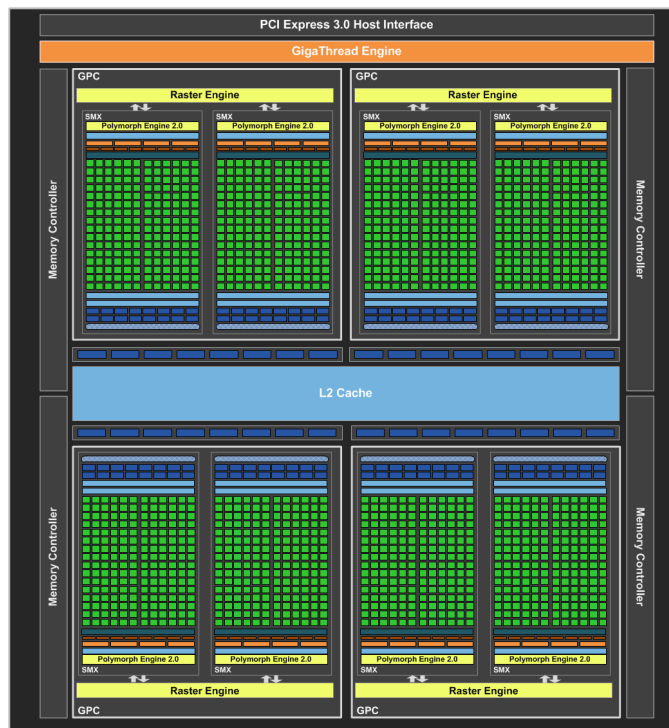
Figure 2.14 – Architecture du processeur graphique Geforce GTX 680 de NVidia.
