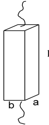
Figure 1.6: Schéma d'un germe représenté sous forme d'un parallélépipède [16].
