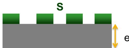
**Figure 4-13 : Schéma de l'évolution de l'interface électrode ( $\text{LiCoO}_2$ )/électrolyte ( $\text{LiBF}_4/\text{GBL}$ ) au cours du premier jour. Possible recouvrement *via* une nouvelle interface conductrice augmentant la surface spécifique.**
