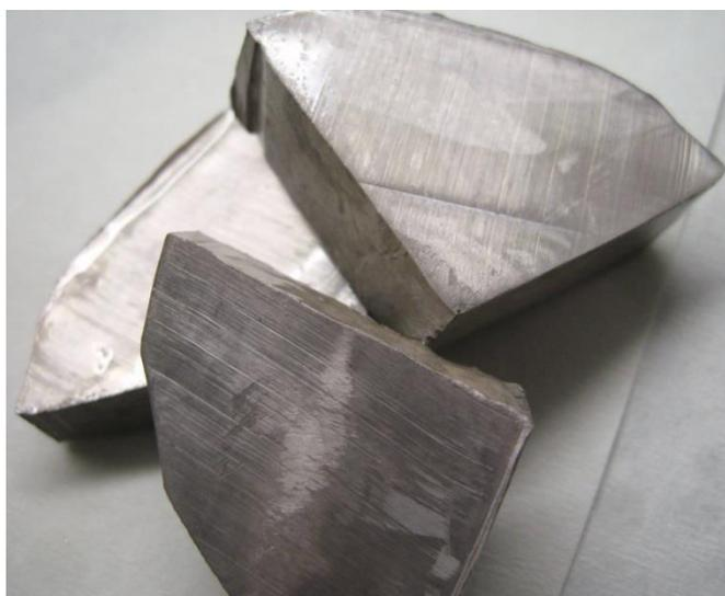
Figure 7 - Photo de sodium solide en l'absence d'air [12]
