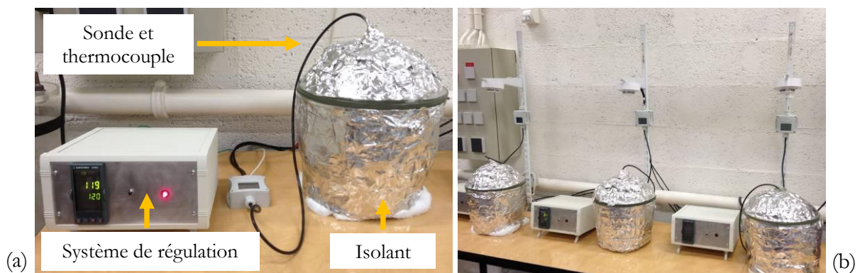
Figure 161. (a) Système de conditionnement humide mis en place à l'institut P'. (b) Placement des systèmes – Vue d'ensemble.
