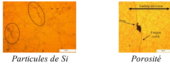
Figure I. 24. Emplacement de l’amorçage de fissure [23]
