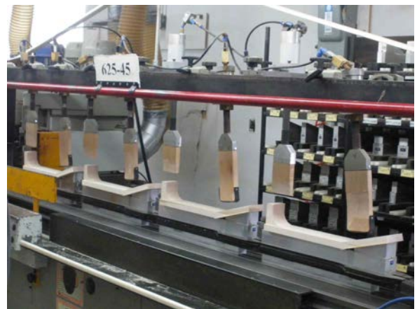
FIGURE 5.12 – Usine du fabricant Godin : machines utilisées pour le collage de la tête et du talon au manche.
