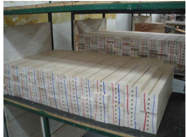
FIGURE 5.10 – Usine du fabricant Godin : manches bruts avec pré-découpe de la tête (à recoller ultérieurement) et rainure pour l’insertion de la truss-rod .
