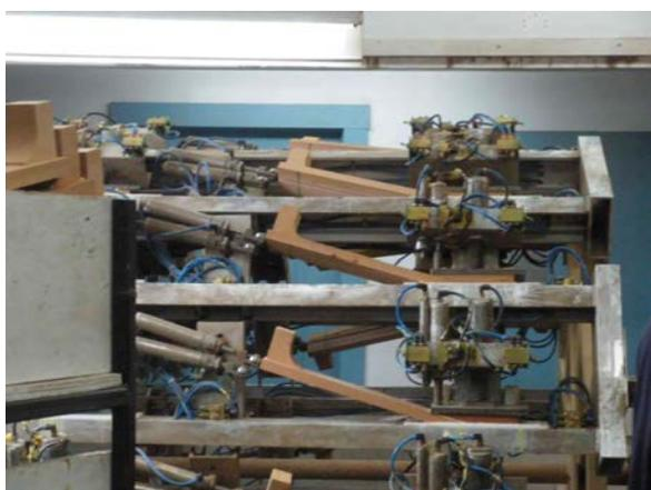
FIGURE 5.13 – Usine du fabricant *Godin* : machines utilisées pour le collage de la tête au manche.
