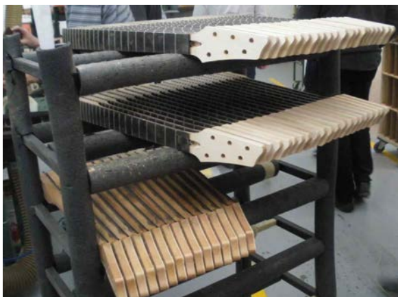
FIGURE 5.11 – Usine du fabricant Godin : un petit lot de manches (modèle xtSA ) de guitare électrique avant leur fixation (par quatre vis) à des corps.
