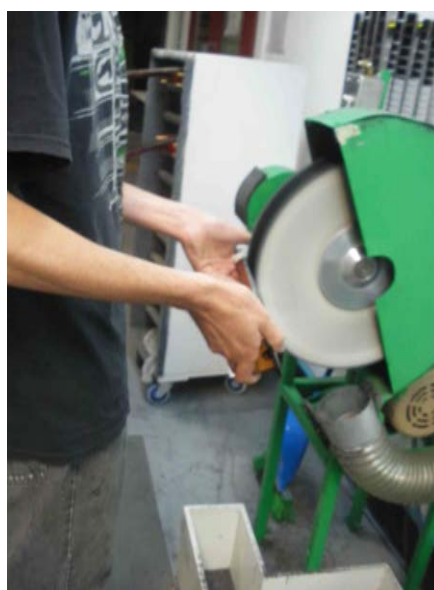
FIGURE 5.14 – Usine du fabricant Godin : une des étapes semi-manuelles de la construction d'une guitare électrique : les frettes sont polies pour uniformiser leur hauteur.
