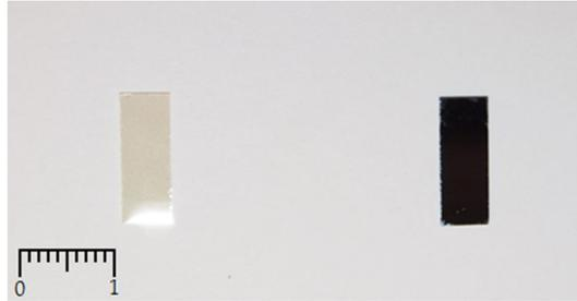
**Figure 6** – Photographie de deux monocristaux de rutile  $TiO_2(110)$ . Le cristal de gauche correspond à un échantillon stoechiométrique et le cristal de droite à un échantillon ayant subi environ 20 recuits de 10 minutes à 1000 K.
