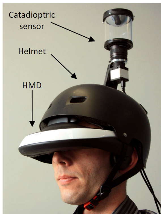
Figure A.4 – Le prototype FlyVIZ. Il combine une caméra omnidirectionnelle et un visio-casque
