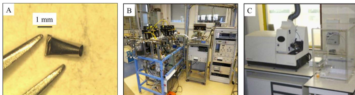
Figure 7 : Photos (A) d'une capsule en platine dans laquelle est placé un zircon à analyser, (B) du spectromètre de masse utilisé au CRPG pour quantifier le ^4\text{He} (VG 603) et (C) de l'ICP-MS du SARM utilisé pour mesuré U, Th et Sm.
