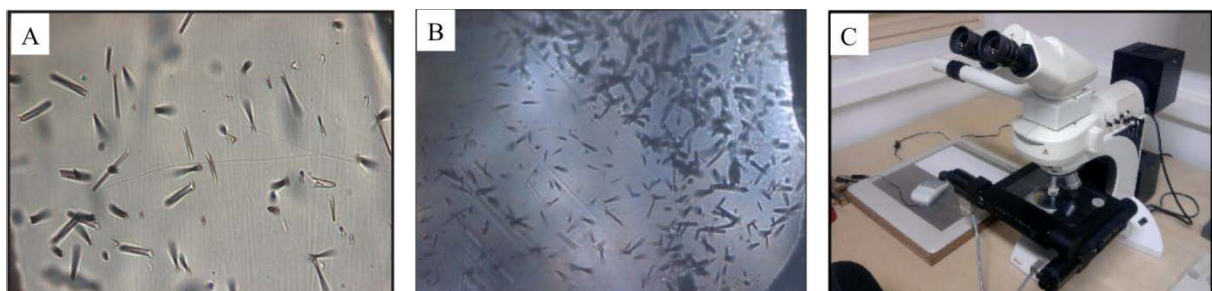
Figure 11 : Photos (A) de traces de fission sur une apatite et (B) sur un zircon. (C) Photos du microscope optique utilisé à l'ISTERRE.
