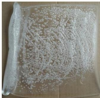
**Figure 122 : Essai sous les IR courts (10 u.a.) pendant 1min (cas extrême)**
