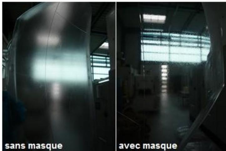
Figure 169 : Photos de pièces automobiles (glaces) vernies (M35) avec et sans masque conducteur (pièce à 40°C et vernis à 20°C avant l’application)
