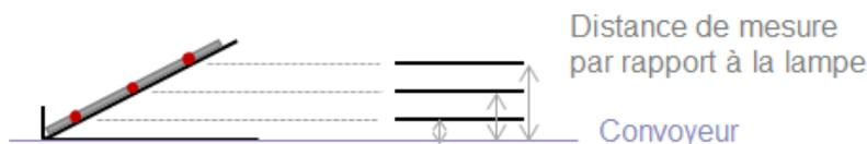
**Figure 114 : Schéma de correspondance entre les mesures sur support incliné et support horizontaux**
