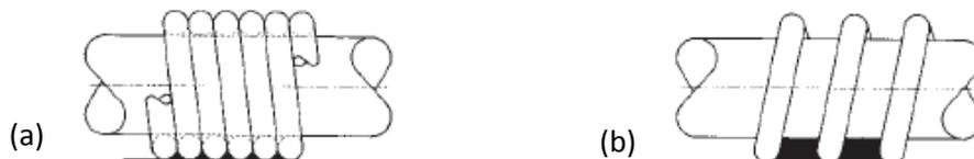
**Figure 37 : Espacements étroits (Close Wound) pour des épaisseurs entre 4 et 120 $\mu\text{m}$  (a) ; espacements ouverts (Open Wound) pour des épaisseurs jusqu'à 500 $\mu\text{m}$  (b) Source RK Princoat instruments**
