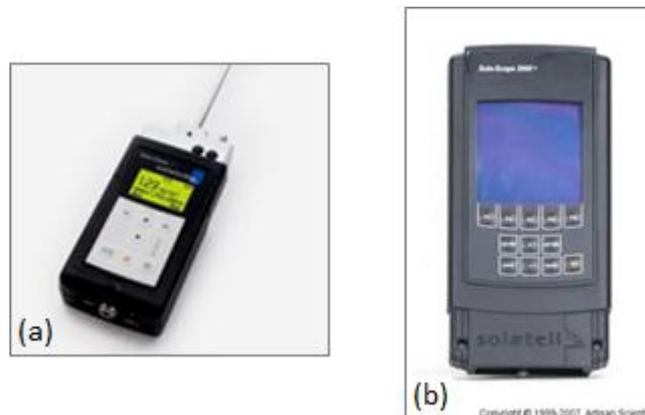
**Figure 49 : Les deux composants du Solascope : le boîtier Détecteur (a) et Analyseur (b)**
