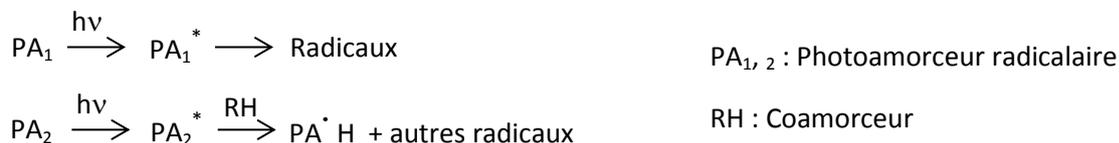
Figure 13 : Schéma de réaction du photo-amorceur radicalaire avec la lumière
