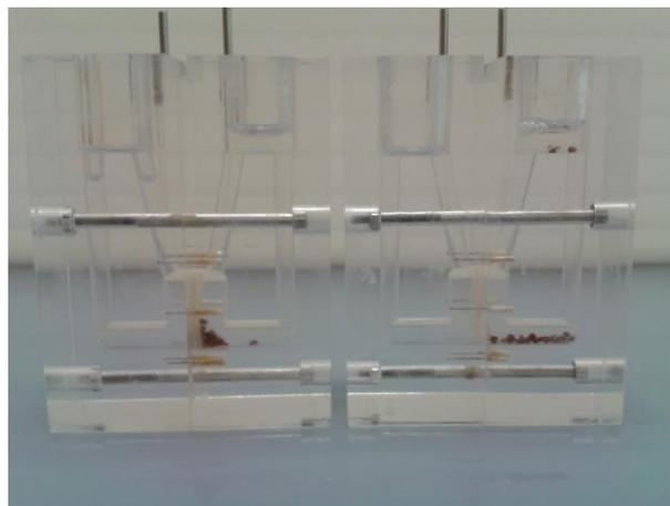
**Figure III-14 : Photographie des cellules de Ussing en fin d'expérience, à gauche ASP6 avec aimant et à droite ASP6 sans aimant.**
