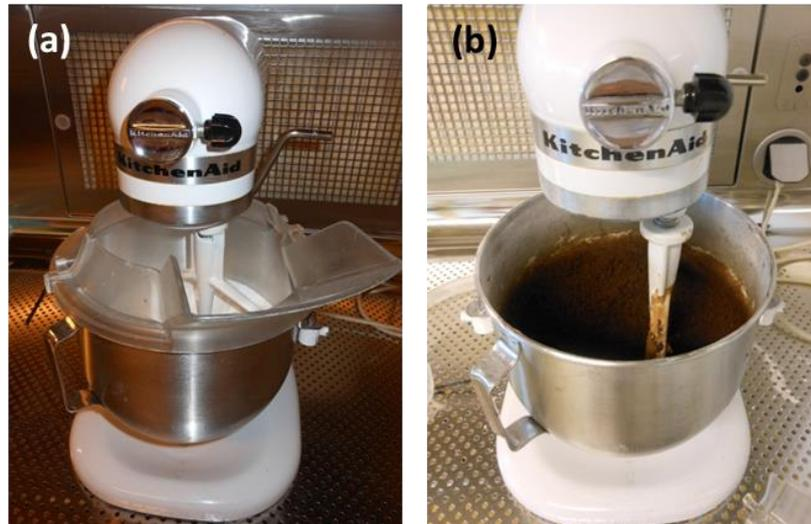
**Figure A5-1 : Photographies (a) du mélange de poudre et (b) après mouillage des poudres avec le ferrofluide.**
