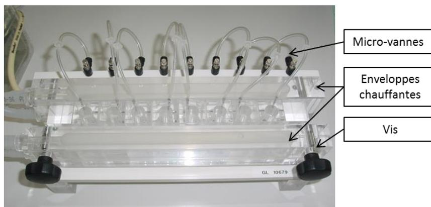
Figure A6-10 : Photographies des cellules de Ussing montées.
