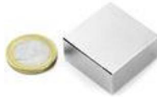
Figure A4-1 : Aimant utilisé *ex vivo* (L=30mm, l=30mm et h=15mm).
