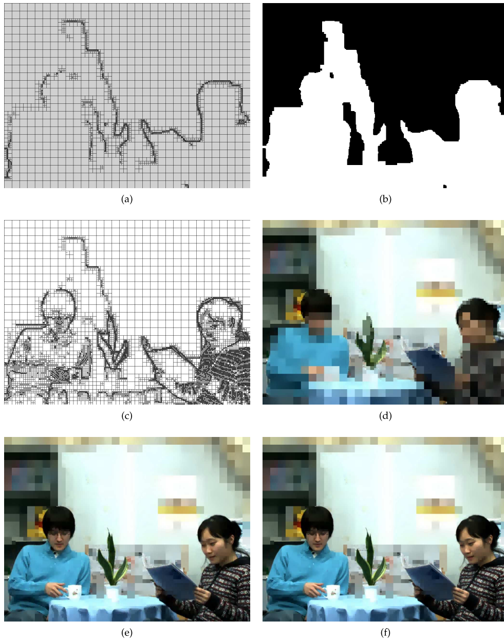
FIGURE 115. Comparaison de la qualité visuelle de la texture de Newspaper vue 6 image 1 avec Th_{Quad} = 46 , Q_p = 69 : (a) Quad_Z ; (b) Masque-DoI; (c) Quad_{ZT-DoI} ; (d) texture Basse Résolution à 0.04 bpp (PSNR Global = 18.2 dB); (e) texture avec la résolution locale raffinée à 0.1 bpp (PSNR DoI = 24.69 dB); (f) texture avec raffinement de résolution locale et de qualité SNR ( Q_{p\_Ref\_T\_DoI} = 20 , Q_{p\_Ref\_T\_NDoI} = 69 ) à 0.31 bpp avec Z_{in\_l} = 63 , Z_{in\_h} = 255 , F = 3 (PSNR DoI = 26.52 dB).
