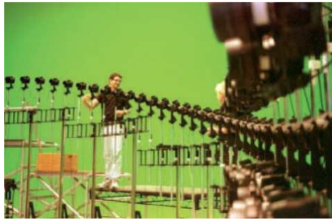
(a) Système d'acquisition avec 120 caméras pour le tournage de Matrix Warner Bros (effet bullet time)
