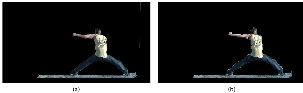
FIGURE 114. Région d'intérêt extraite de la texture codée par RoI en utilisant (a) le Masque-DoI à pleine résolution ; (b) le Masque-DoI avec une résolution en blocs 16x16.
