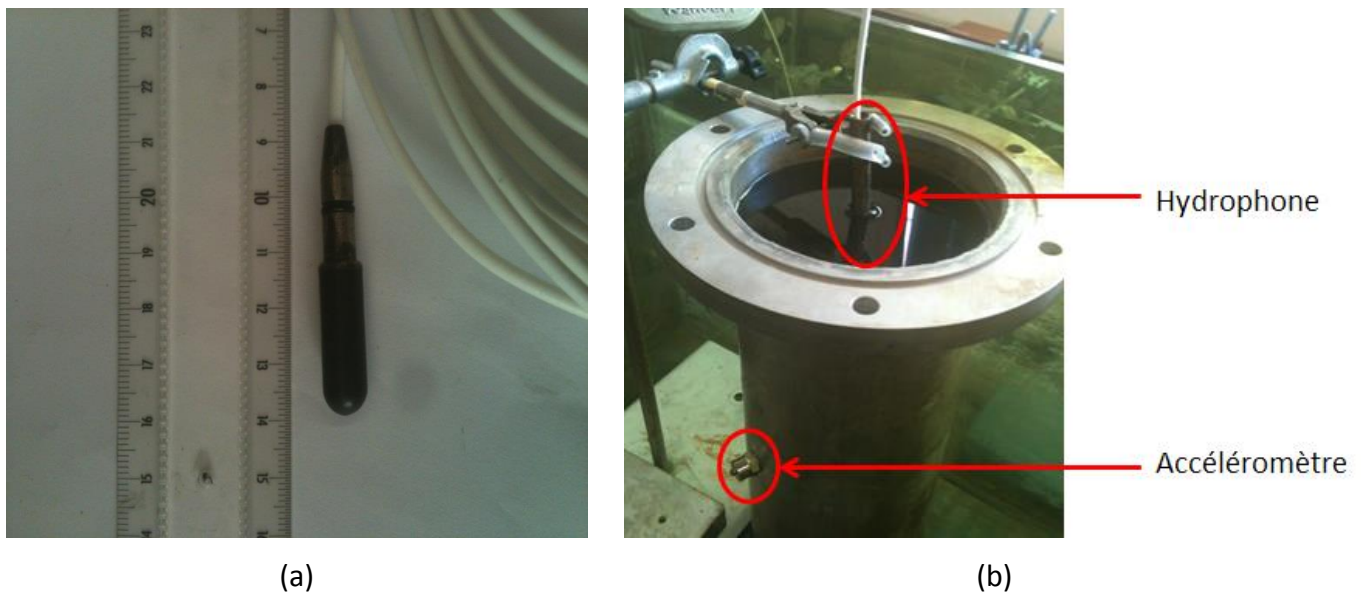
Figure 4.5. (a) Hydrophone B&K 8103 utilisé comme émetteur ; (b) Photo de l'expérience préliminaire réalisée.
