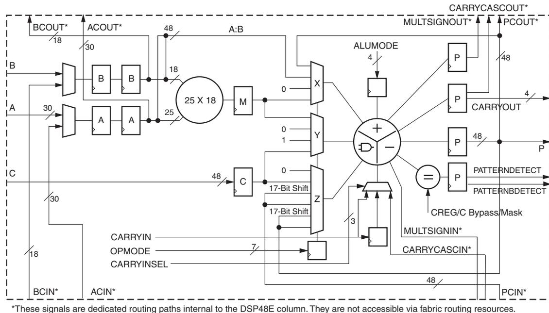
FIGURE 1.11 – Schéma de bloc DSP Virtex 5 issu de [2].
