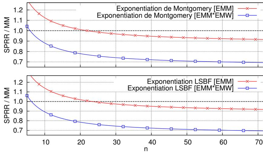
FIGURE 3.3 – Comparaison théorique des performances (EMM) et du coût (EMM  $\times$  EMW) des algorithmes SPRR et MM pour les algorithmes d'exponentiations 22 (échelle de Montgomery) et 5 (LSBF, poids faibles en tête).
