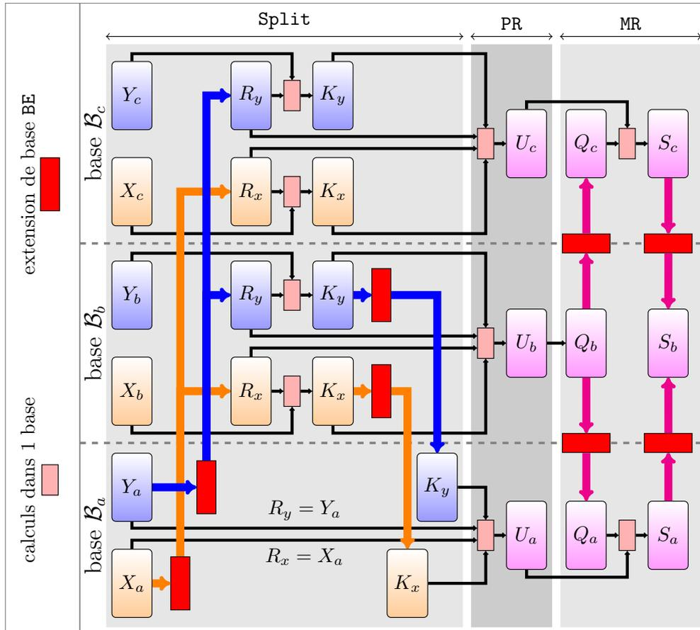
FIGURE 3.1 – Flot de calcul dans l’algorithme SPRR.
