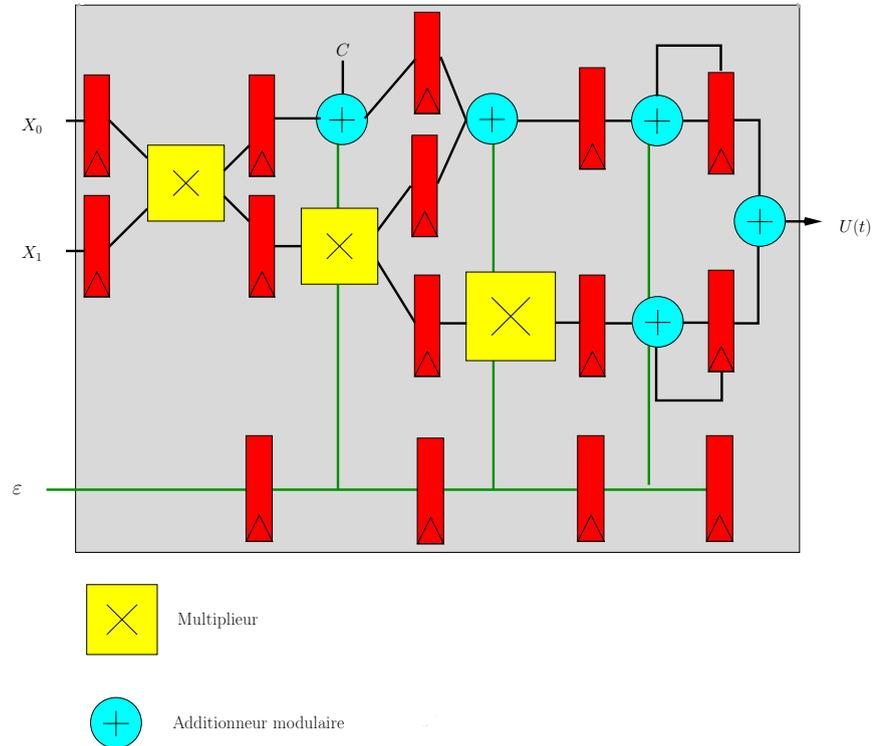
FIGURE 1.9 – Unité arithmétique contenue dans un Rowex pour ECC (source [54]).
