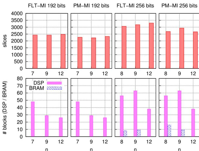
FIGURE 2.5 – Histogramme des surfaces occupées pour les implantations sur FPGA Virtex 5 pour les corps du NIST de 192 et 256 bits.
