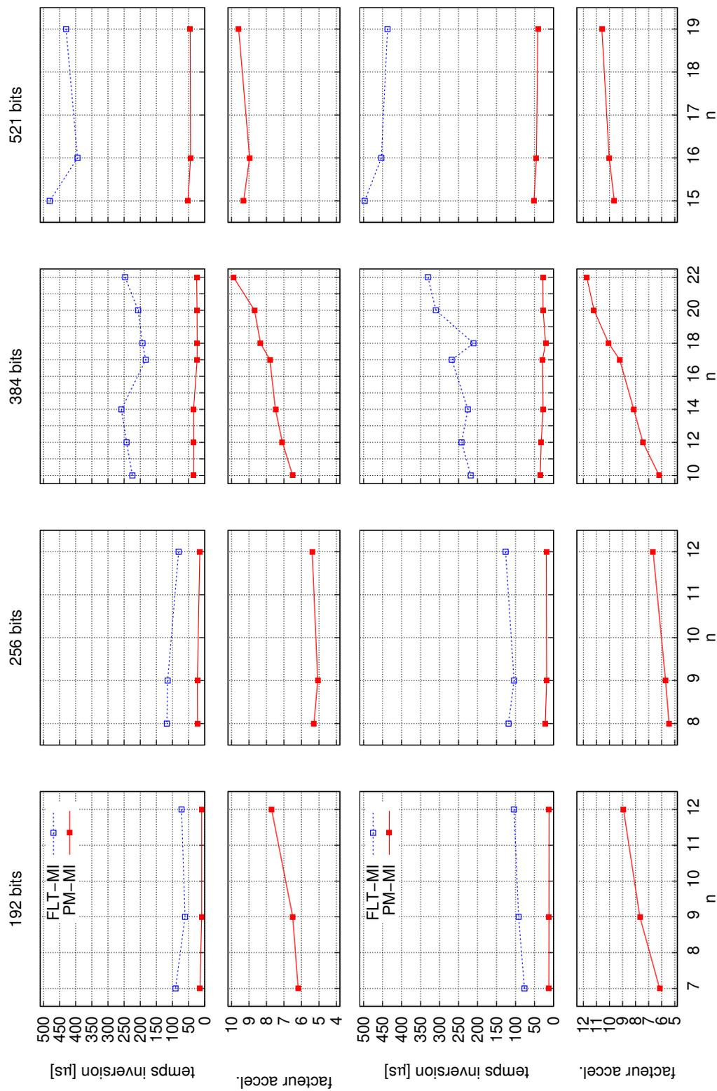
FIGURE 2.4 – Courbes des temps d'exécution et facteurs d'accélération des implantations FPGA des algorithmes FLT-MI et PM-MI, avec blocs DSP et BRAM activés (en haut) et désactivés (en bas) ; pour 4 tailles de corps du NIST et différentes paires  $(n, w)$ .
