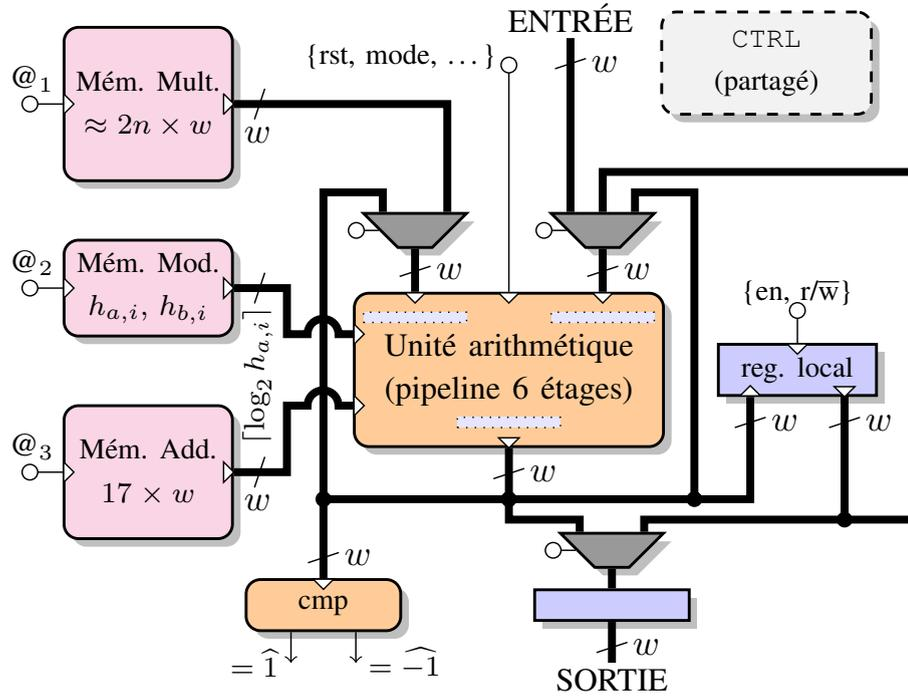
FIGURE 2.3 – Architecture du Rower implanté pour l'inversion PM-MI.
