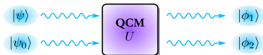
FIGURE 1.3 : Schéma de principe d'une cloneuse quantique (QCM, pour "Quantum Cloning Machine"). Un qubit inconnu |\psi\rangle est cloné sur un état vierge |\psi_0\rangle par une opération unitaire U . En sortie, deux états |\phi_1\rangle et |\phi_2\rangle , sont obtenus et sont, idéalement, des copies identiques de l'état |\psi\rangle .
