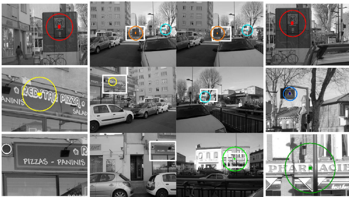
Figure II-53 Système à double résolution : les 6 images centrales (colonnes 2 et 3) correspondent aux vues basses résolution de l'ensemble du champ visuel. Dans les zones d'intérêt (déterminées à partir des détections visuelles ou d'autres heuristiques liées à l'énergie locale, à des hypothèses sur la scène ou au suivi de cibles) sont effectués des zooms depuis l'image originale, de sorte à fournir pour chacune une deuxième image de même taille (320x240), qui correspond à une sous-partie de la vue globale. Les zones sélectionnées pour ces zooms sont illustrées par des rectangles blancs dans les images centrales, et les images résultantes sont affichées sur les côtés (colonnes 1 et 4).
