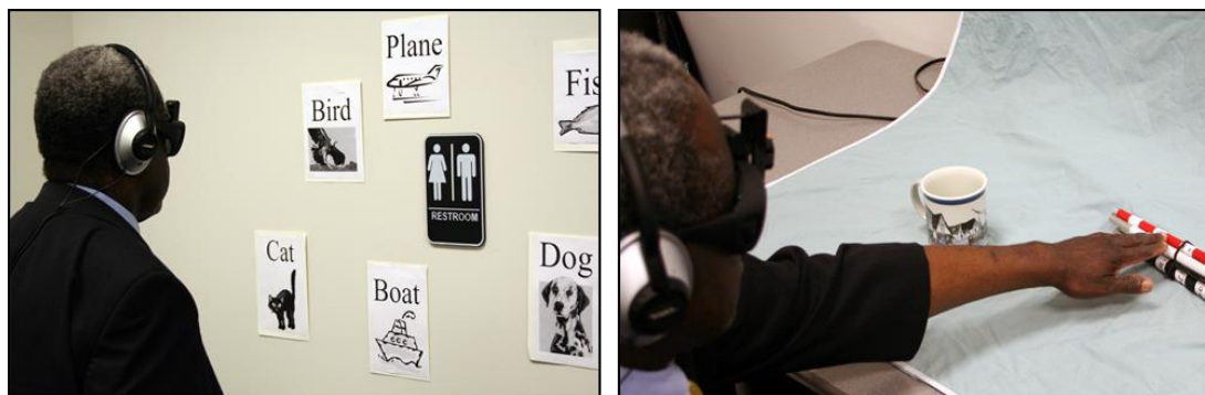
Figure I-46 Expérimentation du dispositif proposé dans [Cheng et al., 2008] permettant de localiser des objets grâce à une interface sonore et aux descripteurs SIFT.
