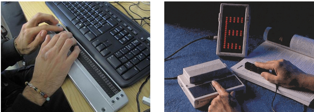
Figure I-9 À gauche, plage braille permettant la lecture sur ordinateur ; à droite, dispositif Optacon.
