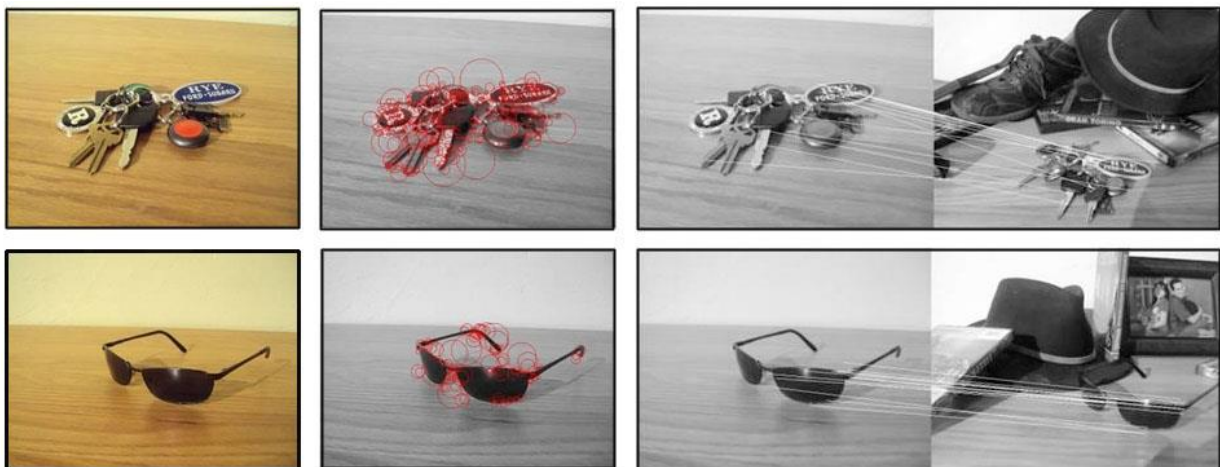
Figure I-45 Détection d'objet par descripteur SURF [Yi et al., 2013]. De gauche à droite : image originale, extraction des points d'intérêt pour le calcul des histogrammes SURF, et matching de ceux-ci dans une nouvelle image.
