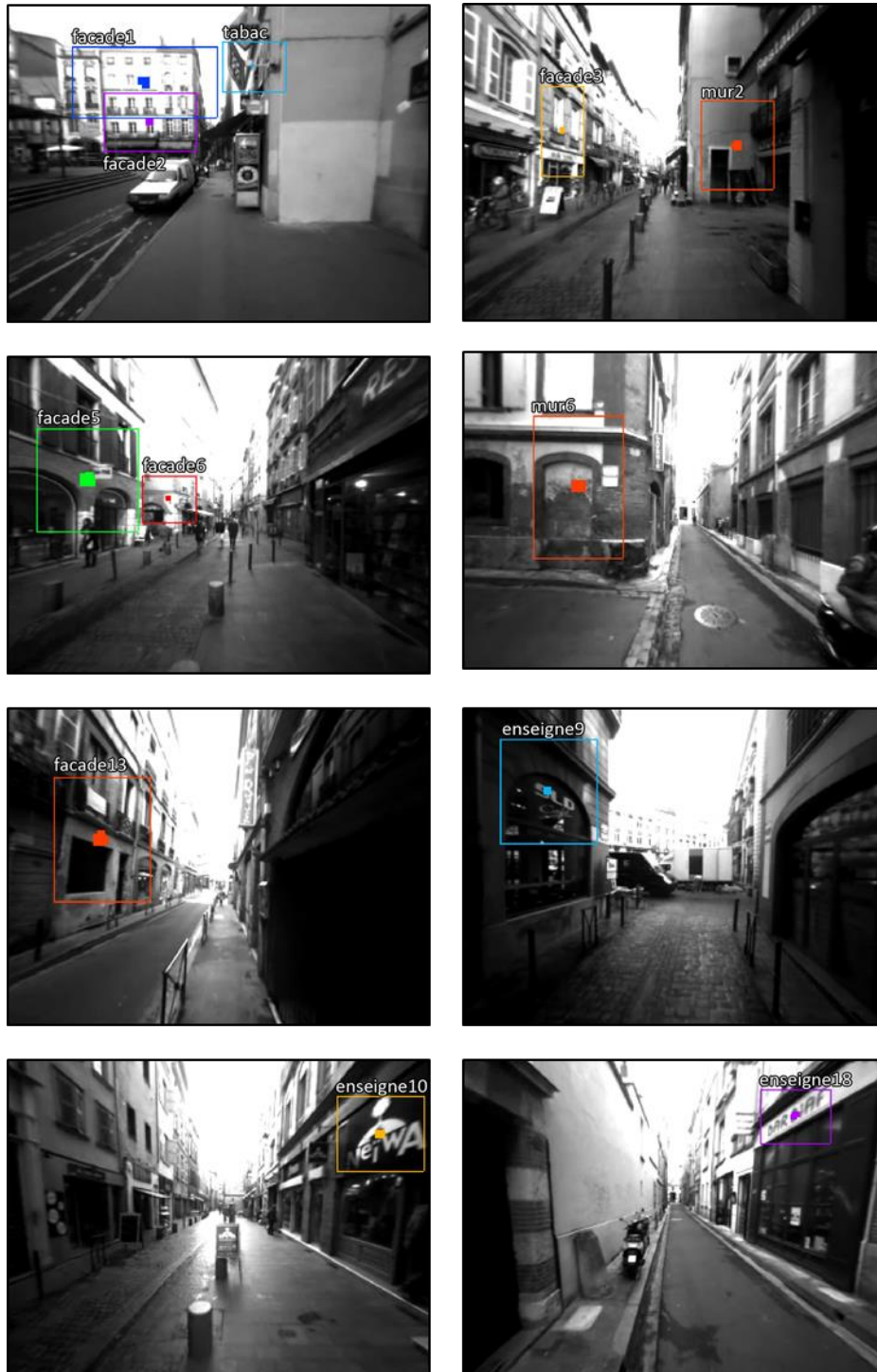
Figure II-46 Exemples de points visuels du trajet des Carmes (cibles géolocalisées permettant la correction du GPS).
