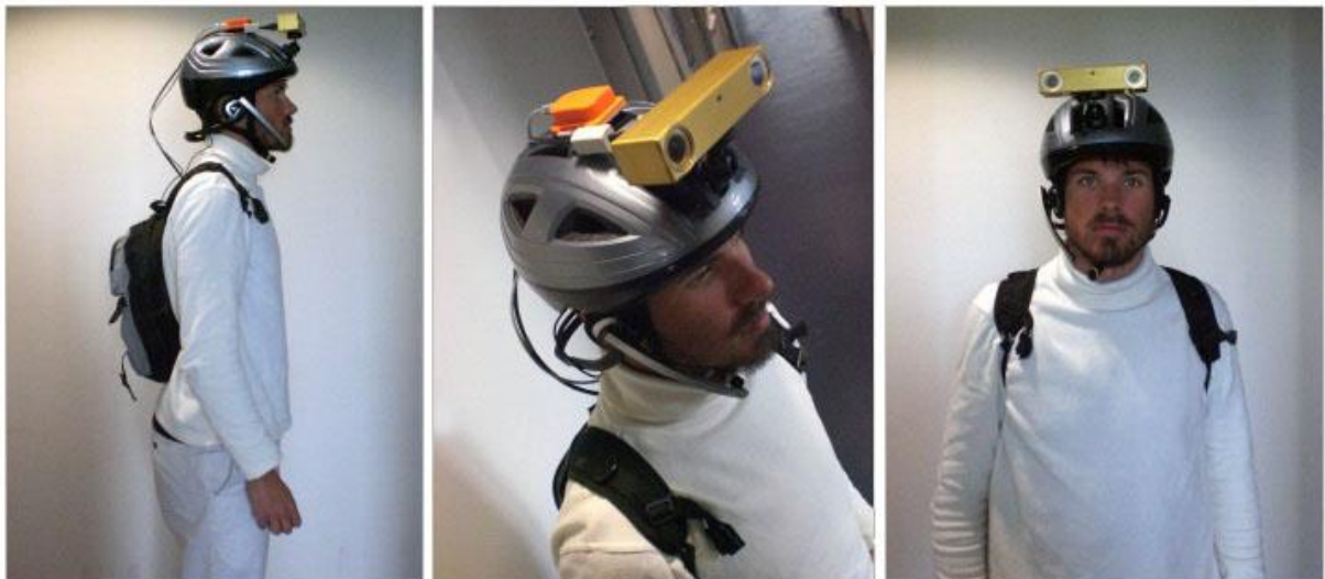
Figure II-2 Prototype Navig comprenant écouteurs, microphone, GPS, caméras stéréoscopique et centrale inertielle montés sur un casque ainsi qu'un ordinateur portable dans le sac à dos.
