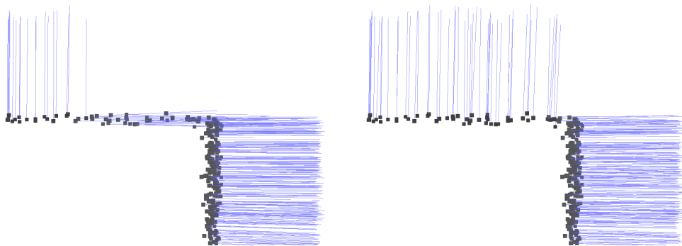
FIGURE 5.11 – Effet de l'anisotropie sur l'estimation de normales. À gauche, Li et al. [2010] et à droite, notre méthode avec tirage quasi uniforme.
