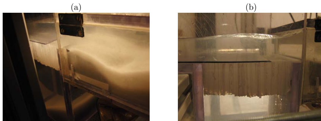
FIGURE 3.7 – Photographies du piège à sédiment en sortie du chenal. (a) Photographie de profil de la sortie du chenal et du raccord avec le piège. Un profil en forme de dos de dune permet d'éviter la formation d'une zone de turbulence élevée. (b) Photographie de la partie haute du piège de 10 cm de long. Une plaque est posée sur le piège de façon à restreindre son ouverture à 3 cm, ce qui correspond à piéger des grains sur une hauteur de 3 \pm 1 mm. Sous la plaque est installée une épaisseur de 4 cm de nid d'abeille.
