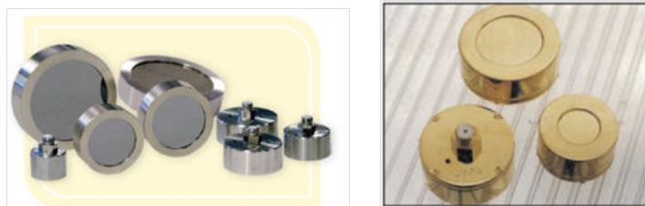
FIGURE 3.10 – La figure de gauche représente des détecteurs PIPS de différents diamètres. Sur l'image de droite sont visibles des détecteurs de type Si(Li).
