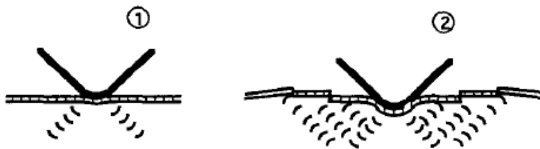
Figure III-10 – Représentation schématique de la nucléation de dislocations à l'extrémité d'un indenteur en diamant : (1) nucléation en volume et (2) rupture de la couche d'oxyde [GERBERICH 1996].
