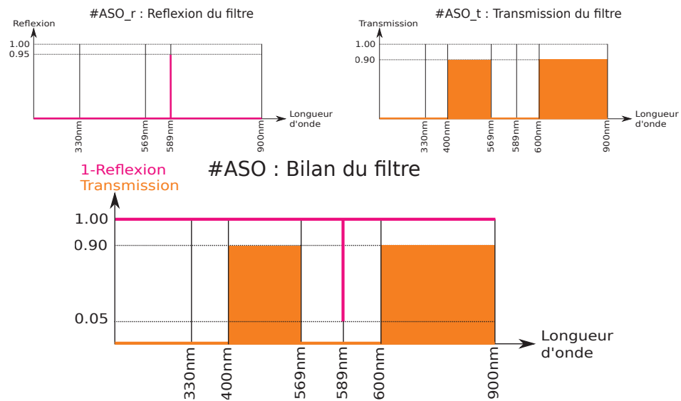
FIGURE 3.19 – En haut à gauche : gabarit de réflexion du filtre. En haut à droite : gabarit de transmission du filtre. En bas : Bilan du filtre.
