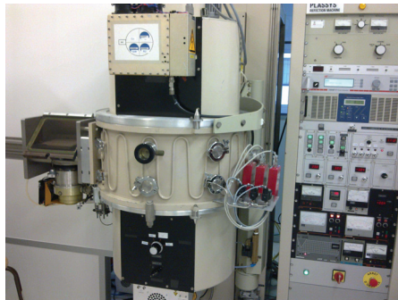
(a) Machine PLASSYS utilisée pour les dépôts par pulvérisation.
