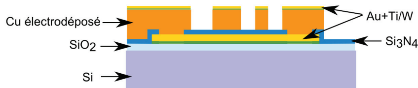
FIGURE 2.2.1: Procédé de fabrication sur un substrat de silicium.
