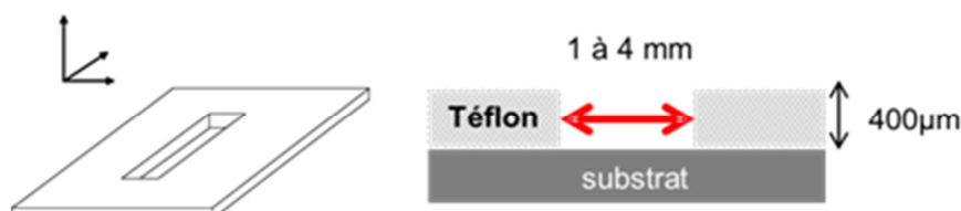
Figure II- 13 : Illustration schématique de la réalisation de cavité artificielle par collage d'un masque usiné laser.
