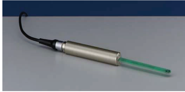
Figure 1.16 : Sonde inductive utilisée par un gaussmètre Brockhaus [63]
