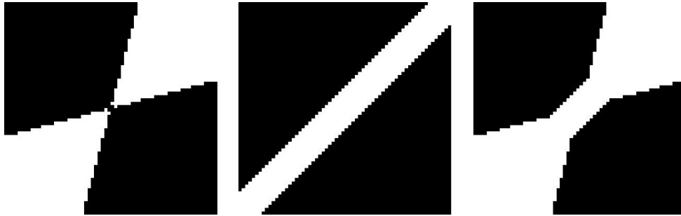
FIGURE 6.12 – Trois stratégies possibles pour la sélection de coefficients pour une direction dominante d'angle \pi/4 .
