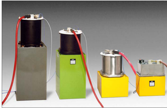
FIGURE 1.1: Modules 50 kJ conçus à l'ISL représentant les différentes évolution au cours du temps. De gauche à droite, les réalisations datent de 1998, 2000, 2001 et 2004
