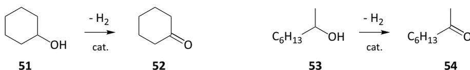
FIGURE 1.19 – Déshydrogénation catalytique du cyclohexanol **51** en cyclohexanone **52** ou du 2-octanol **53** en 2-octanone **54**.
