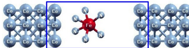
Figure V.11 – Représentation schématique de la jonction Co/FeN_6/Co . La région centrale contient l'octaèdre FeN_6 et deux plans de cobalt suivant la direction (001).
