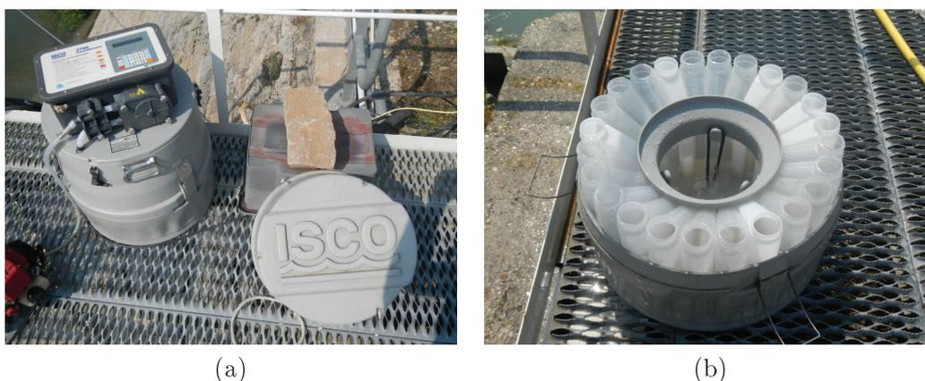
FIGURE 2.2 – Préleveur automatique ISCO (a) et sa couronne de 24 flacons de prélèvement (b).
