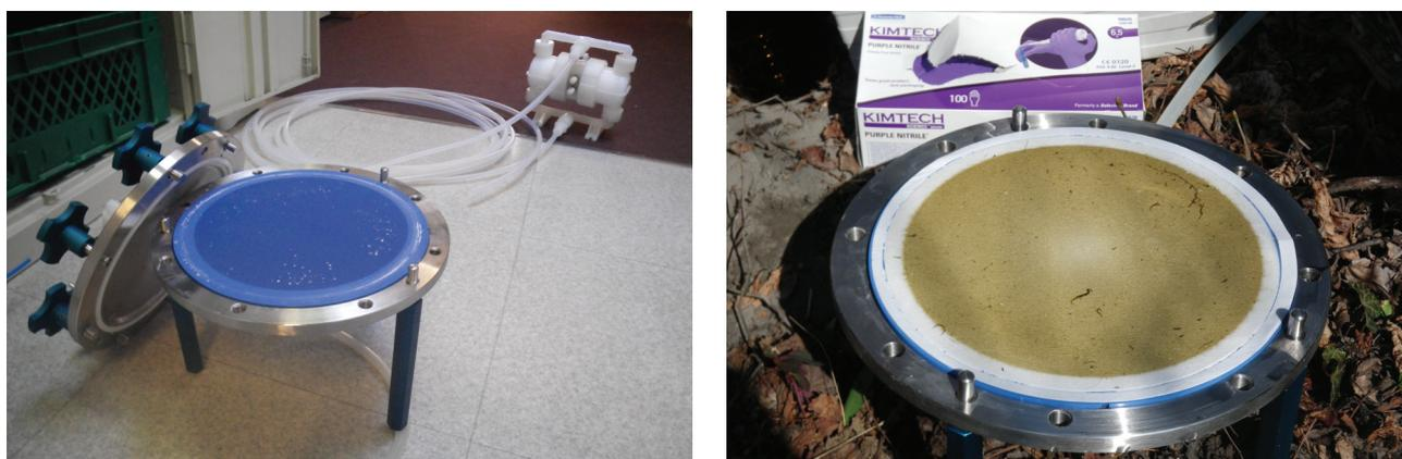
FIGURE D.2 – Système de filtration Millipore et pompe Asti testés puis abandonnés dans cette thèse
