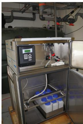
FIGURE D.1 – Préleveur automatique réfrigéré Bühler installé puis désinstallé dans la station de Jons
