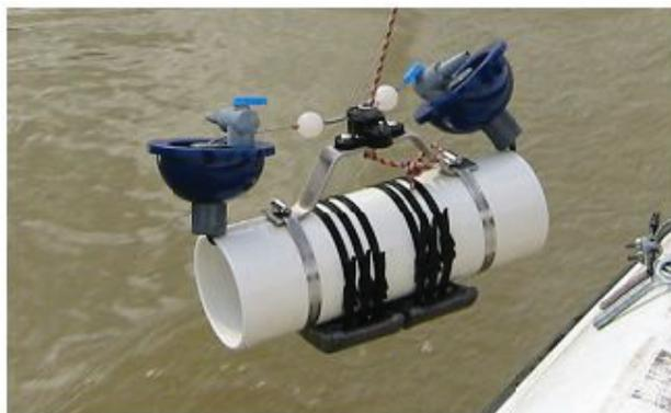
FIGURE 2.1 – Bouteille de prélèvement Niskin
