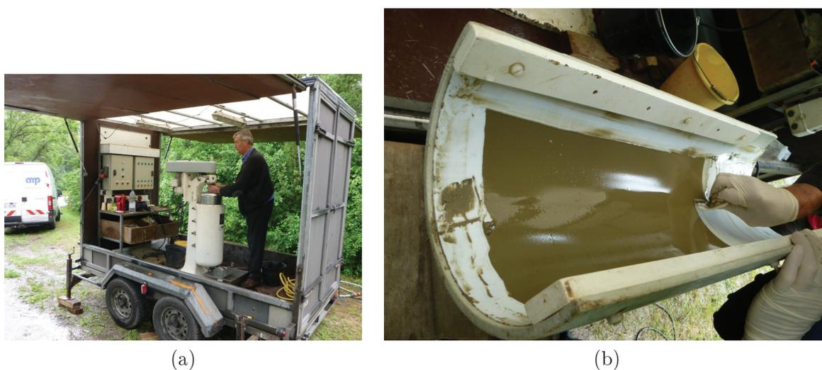
FIGURE 2.5 – (a) Centrifugeuse CEPA de la société AMP et (b) feuille de Téflon extraite du cylindre vertical pour collecter les MES et constituer l'échantillon.
