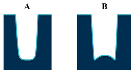
**Figure 53 – Profil de tranchée: (A) énergie ionique insuffisante et (B) énergie ionique en excès**
