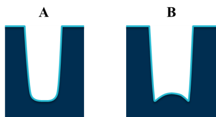
Figure 53 – Profil de tranchée: (A) énergie ionique insuffisante et (B) énergie ionique en excès
