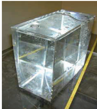
Figure IV-14 : Fantôme plaque ISO rempli d'eau.
