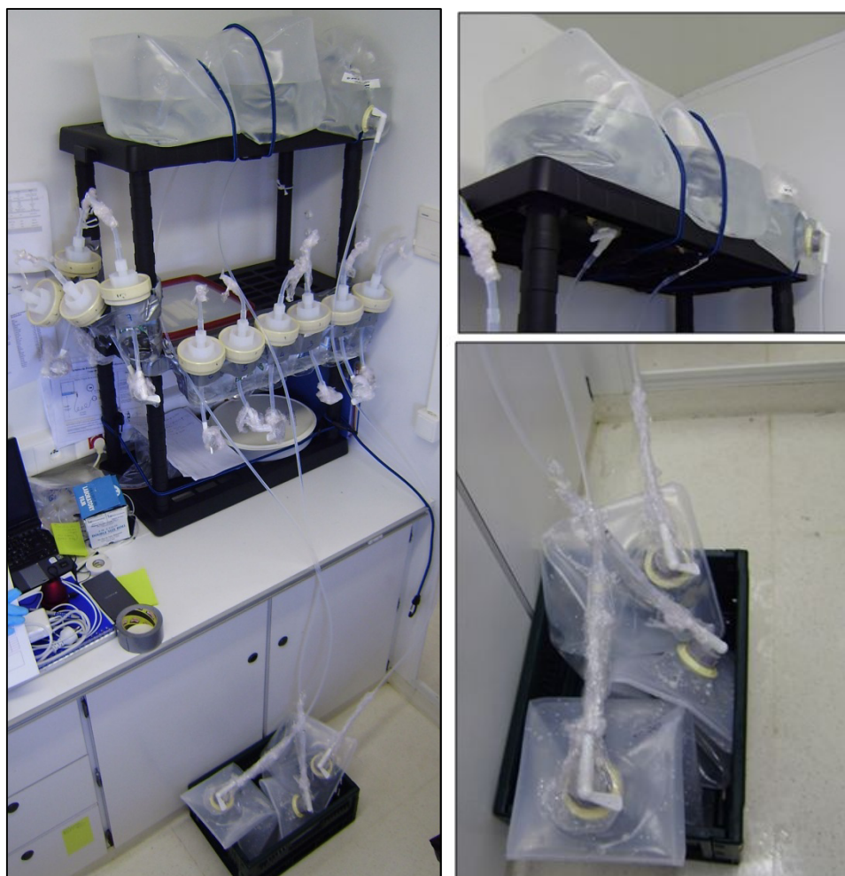
Figure III-4. Préconcentration à bord. Photo du montage de préconcentration à bord du R/V Atalante durant la campagne PANDORA, à l'intérieur du container propre de l'INSU.
