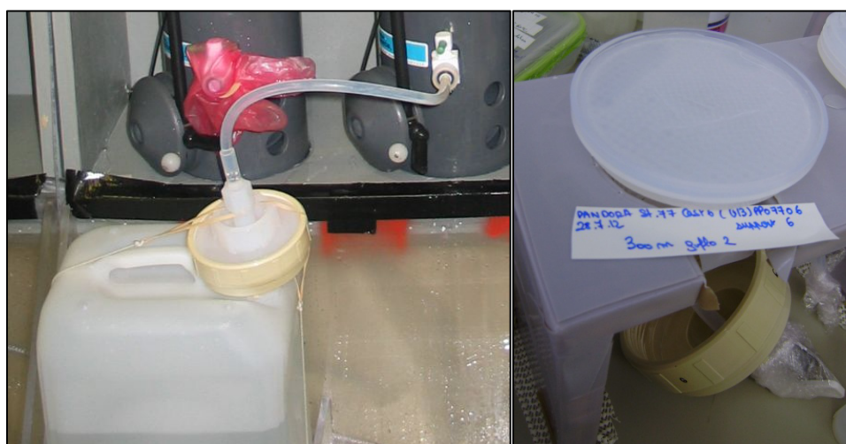
Figure II-4. La filtration. Sur la photo de gauche, entre la bouteille GO-FLO et le bidon de récupération on voit l'unité de filtration fermée reliée via un tuyau PTFE à la bouteille GO-FLO et au bidon de récupération. Sur la photo de droite, on voit l'unité de filtration ouverte après filtration, qui laisse apparaître le filtre. La seconde photo a été prise durant la campagne PANDORA et non pas la campagne EUCFe.
