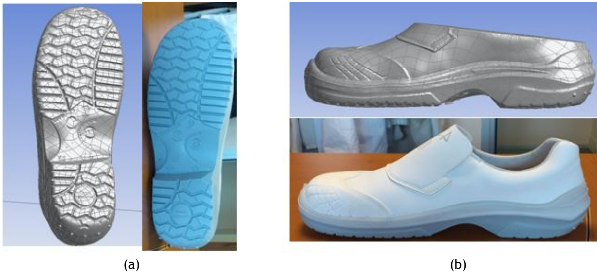
Figure 80 : Images de la chaussure et de sa représentation CAO (a) vue des rainures, (b) vue de côté
