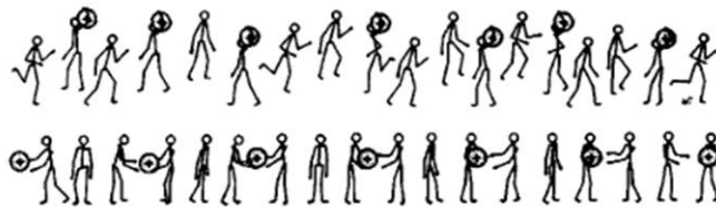
FIGURE I.5 – Mécanismes de conduction protonique : conduction véhiculaire (en haut) et conduction par échange de protons (en bas). Figure extraite de l'article de Kreuer et al. [8]
