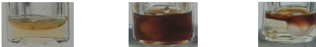
FIGURE III.45 – Photos de quelques mélanges binaires à 150°C. A gauche : mélange de verre et de glycérol (fractions massiques : 0,3/0,7). Au milieu : mélange de verre et undécylimidazole (fractions massiques : 0,83/0,17). A droite : mélange de glycérol et undécylimidazole : (fractions massiques : 0,83/0,17). L'agitateur magnétique utilisé pour homogénéiser les mélanges (avant de les laisser reposer pour atteindre l'équilibre thermodynamique) est visible sur les deux dernières photos.
