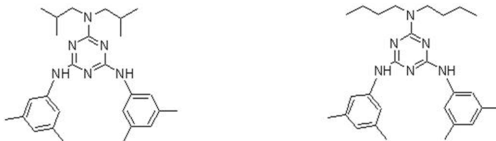
FIGURE III.3 – Structure des verres organiques sélectionnés. A gauche : verre diisobutyl. A droite : verre dibutyl.
