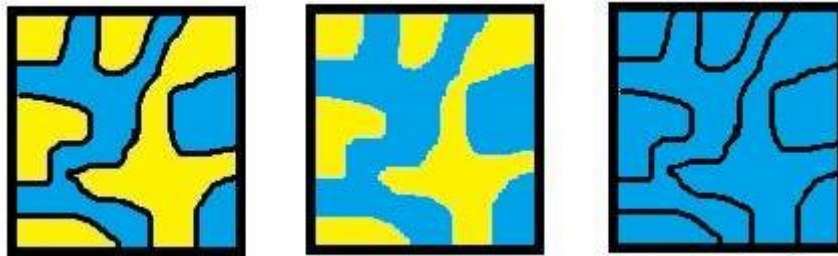
FIGURE B.1 – Variation de contraste en SANS pour un système ternaire eau/huile/tensioactif. A gauche : contraste quelconque entre les trois constituants. Au milieu : annulation du contraste entre le tensioactif et un des deux autres constituants (contraste "bulk"). A droite : annulation du contraste entre l'eau et l'huile (contraste "film").
