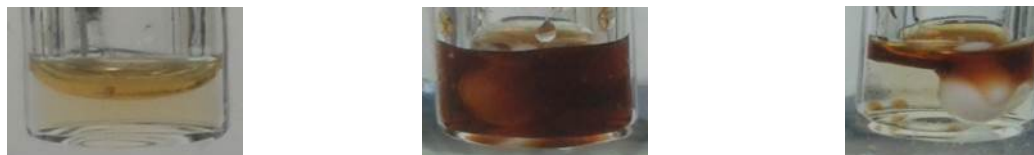
FIGURE III.45 – Photos de quelques mélanges binaires à 150°C. A gauche : mélange de verre et glycérol (fractions massiques : 0,3/0,7). Au milieu : mélange de verre et undécylimidazole (fractions massiques : 0,83/0,17). A droite : mélange de glycérol et undécylimidazole : (fractions massiques : 0,83/0,17). L'agitateur magnétique utilisé pour homogénéiser les mélanges (avant de les laisser reposer pour atteindre l'équilibre thermodynamique) est visible sur les deux dernières photos.
