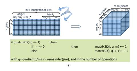
Figure 1.5 – Transformer la relation de contrôle d'accès Booléenne de 3 à 2 dimensions
