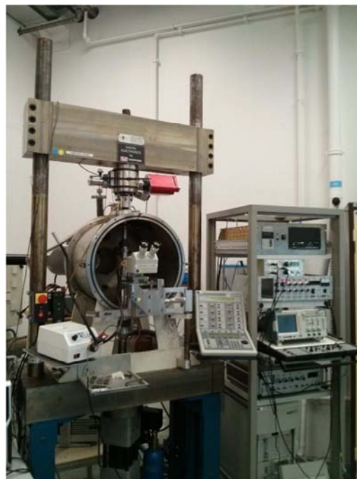
Figure 80 : Machine d'essais de fissuration INSTRON avec enceinte d'environnement.
