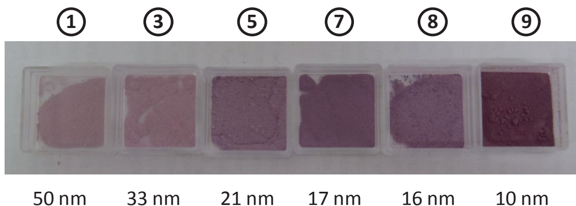
Figure III.45 : Aspect visuel de différents échantillons de [\text{Fe}(\text{Htrz})_2(\text{trz})](\text{BF}_4) présentés ici avec leurs tailles de domaines estimées à travers un modèle isotrope.
