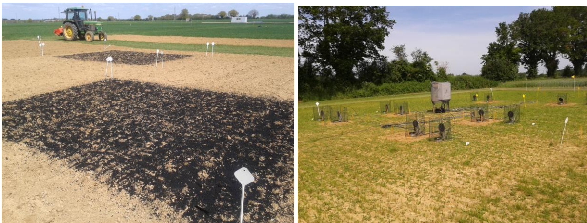
Figure V-2 : Le dispositif expérimental EUROCHAR (ORE ACBB – Lusignan) mesure en continu l'impact d'un amendement de biochar produit par gazéification (30t/ha) sur la respiration du sol avec ou sans végétation.
