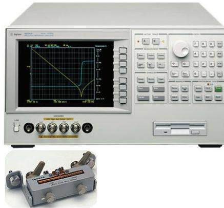
Figure IV-17 : impédancemètre et son module utilisé pour la caractérisation du relais
