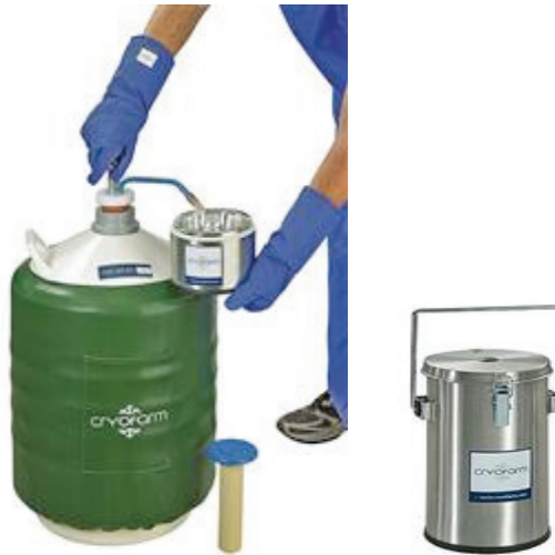
Figure II - 9 : conteneur, pompe de soutirage et cryostat
