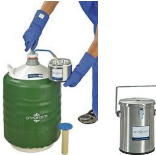
Figure II - 9 : conteneur, pompe de soutirage et cryostat
