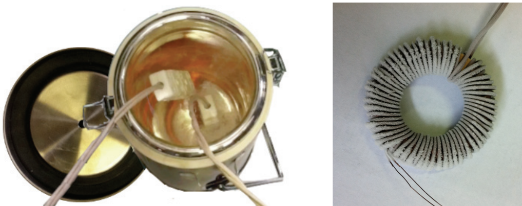
Figure II -10 : à gauche : échantillon dans le cryostat ; à droite : échantillon « givré » après la mesure
