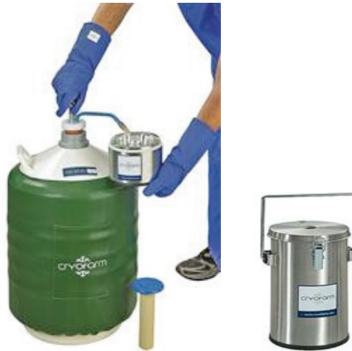
Figure II - 9 : conteneur, pompe de soutirage et cryostat
