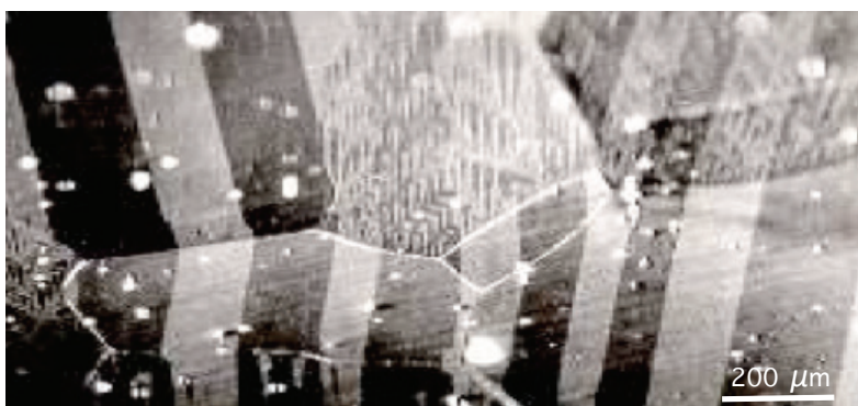
Figure I-9 : distribution en domaines magnétiques d'un alliage polycristallin Fe-3%Si à grains orientés: structure réellement observée [ APERAM ]
