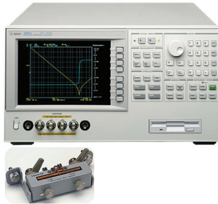
Figure IV-17 : impédancemètre et son module utilisé pour la caractérisation du relais
