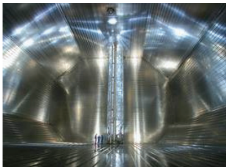
Intérieur d'une cuve de méthanier
