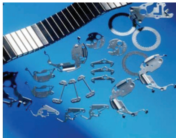
Figure A-I-1 : a) moteur électrique de montre du type LAVET, b) pièces de montres et de contact, ressorts [APERAM]
