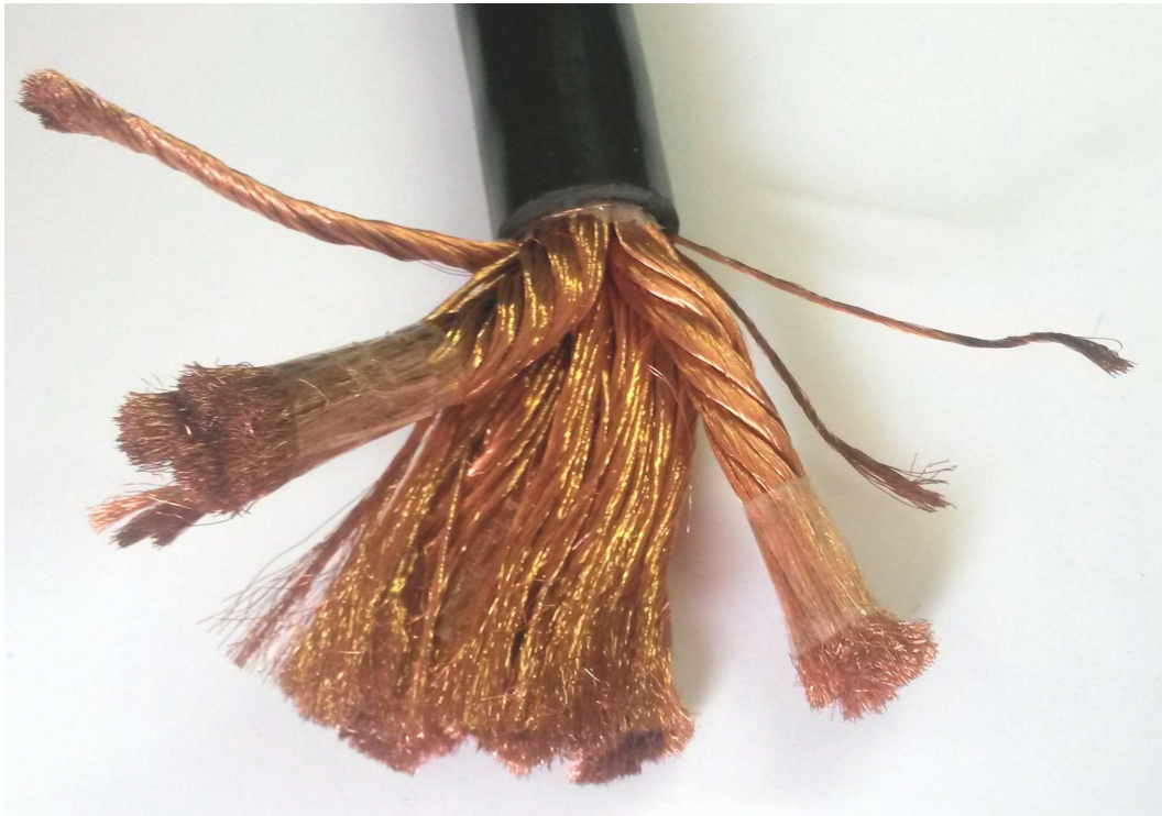
FIGURE 2.1 – Exemple d'inducteur multibrins comptant environ 20 000 brins en cuivre.
