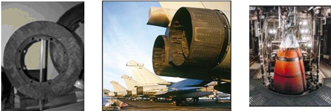
Figure 1 : Exemple d'utilisation de composites thermostructuraux: freins (à gauche), sortie de réacteur d'avion (au centre), divergent déployable de fusée (à droite)
