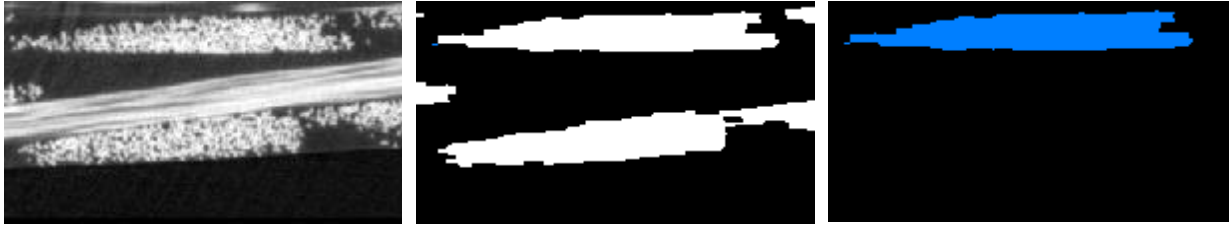
Figure 46 : Sélection de tronçons sur une coupe orthogonale. A gauche : section d'une image originale. Au milieu : masque binaire des fils de trame résultant du seuillage. A droite : résultat de la sélection des tronçons de fils isolés. Seule la composante connexe représentée en bleue a été retenue.
