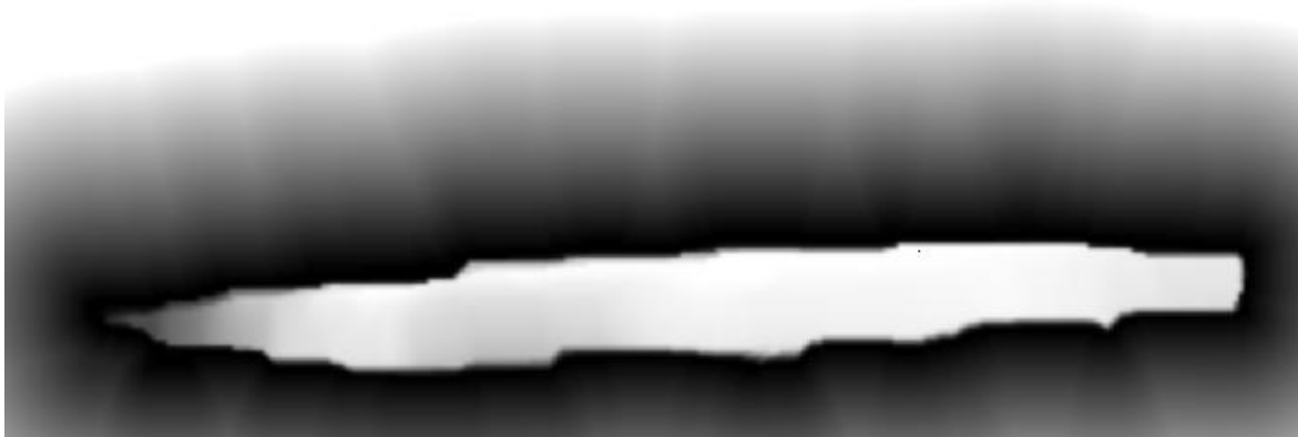
Figure 110 : Tranche du bloc d'entrée à basse résolution avec carte de distance à l'enveloppe (allant de 0 à 458 pour une échelle respectivement allant de noir à blanc) et densité (la densité a été artificiellement augmentée pour être visible dans cette figure, son échelle va de 0 à 1 pour respectivement s'étaler du noir au blanc)
