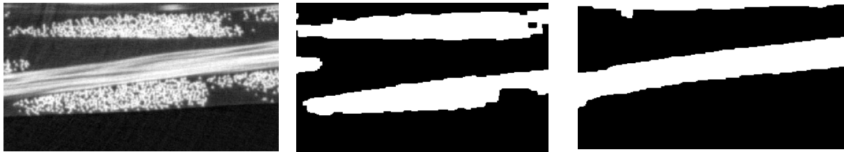
Figure 45 : Image initiale (à gauche), enveloppe de fils de chaîne (au centre), enveloppe de fils de trame (à droite)
