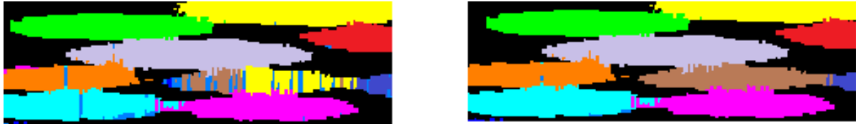
Figure 64 : A gauche : sections en vue de dessus de quelques fibres avant application de l'algorithme de poursuite ( en bleu foncé les pixels non labélisés, en couleur vives les pixels labellisés, en noir la résine). A droite : résultat après application de l'algorithme de poursuite (à droite)
