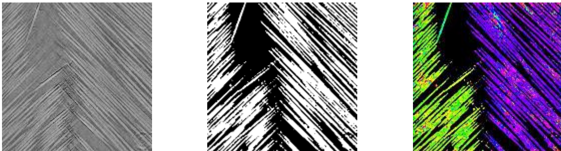
Figure 12 : Calcul d'orientation par [ALT 09] : section de l'image initiale (gauche), segmentation (centre), résultat (droite)
