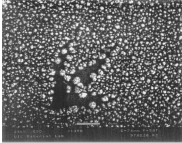
Figure 14 : Image M.E.B de noir de platine utilisé dans les PEMFC [4] .
