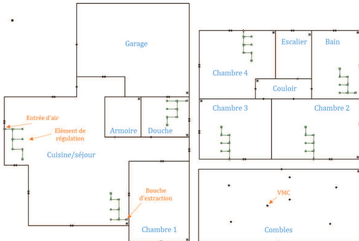
Figure IV.3 – Modèle de la maison sous CONTAM : VMC HB
