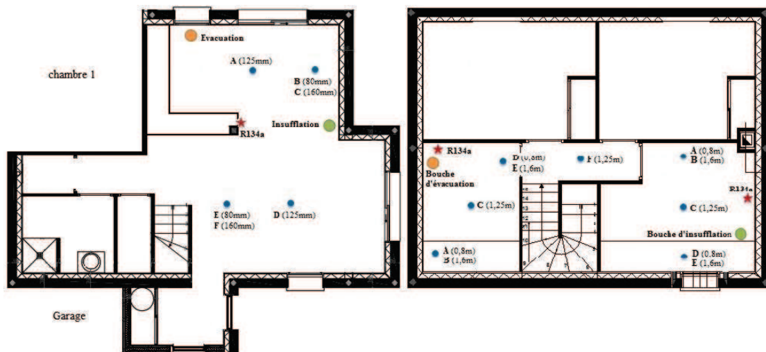
Figure III.34 – Tests préliminaires : Points de mesure
