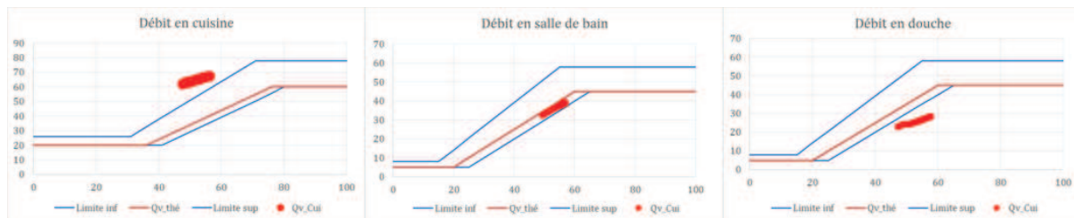
Figure IV.22 – Débits d'extractions mesurés en fonction de l'humidité relative : VMC HB, Séj-PF
