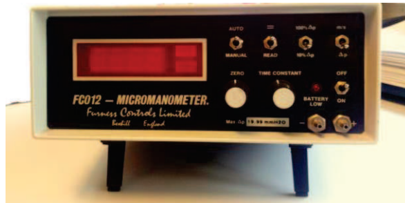
Figure III.20 - Différentiel de pression FCO 12
