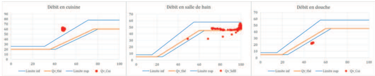
Figure IV.25 – Débits d’extractions mesurés en fonction de l’humidité relative : VMC HB, SdB-PF
