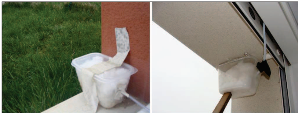
Figure III.21 - Mesure de la pression statique
