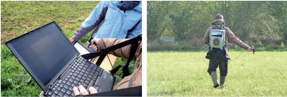
Figure 1.28 – Calibration du spectro-radiomètre (à gauche) et collecte de profils spectraux (à droite)
